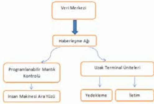
Şekil 1: SCADA Sistemlerinin Bileşenleri[2]
